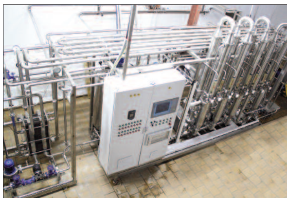
Установка «ВОДОПАД» 36,15-4-138» производительностью 580 кг творога в час (г. Саратов, ООО «Комбинат детского питания») и продукты, вырабатываемые на установке
