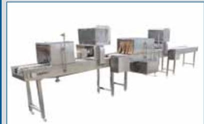
Для предотвращения появления плесени на головках сыра в процессе созревания и хранения внедрен в производство комплекс оборудования, формируемый в единую линию.
